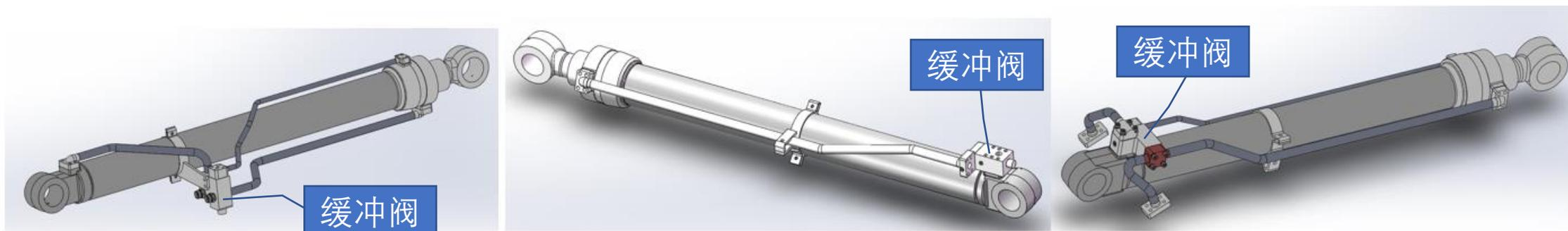
220挖机大臂缸结构图
