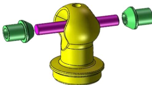
一字销轴在工作时两端受相反方向的平衡拉力，具有比同等直径的十字轴更强的承载能力，整轴采用翼型结构设计方案，如将传动轴两端的联接法兰与上下动力端的联接法兰合二为一，可减少两个法兰盘。
